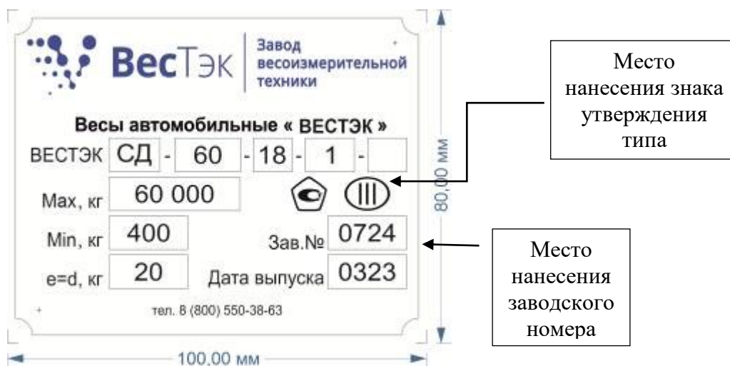
Рисунок 1 – Пример маркировочной таблички с указанием места нанесения знака утверждения типа, заводского номера
