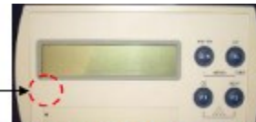
Пломбировка доступа к переключателю режимов настройки и юстировки на передней панели корпуса приборов модификаций WE2107, WE2108
